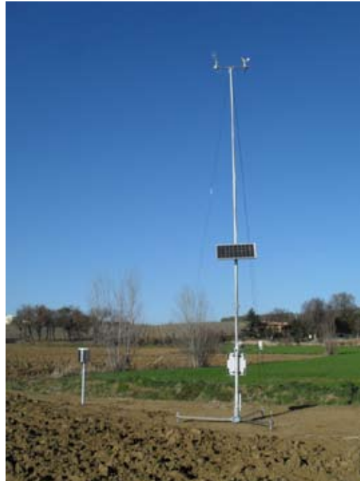
Figura 3: Stazione meteorologica alimentata da pannello solare fotovoltaico
