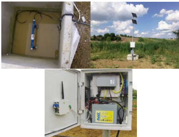
Figura 7: Sonde spettrofotometriche, sistema di alimentazione e sistema di acquisizione e memorizzazione dati
