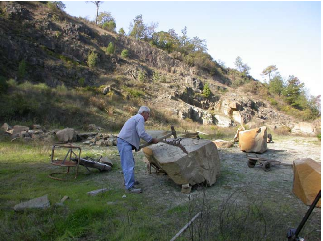
L'apertura di un blocco di Pietra Macigno con i punciotti
