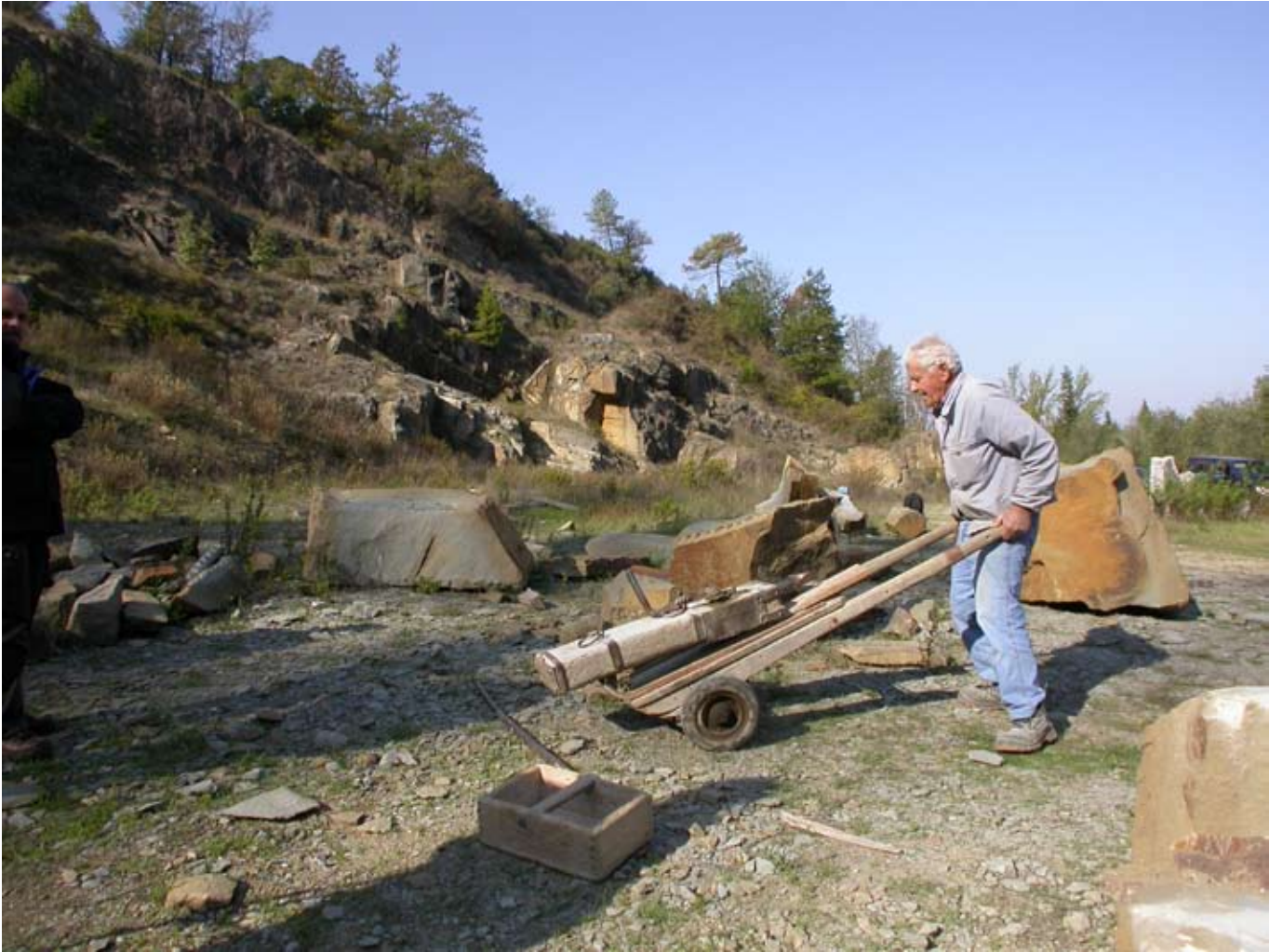
La movimentazione in cava: l'uso della binda e del carretto
