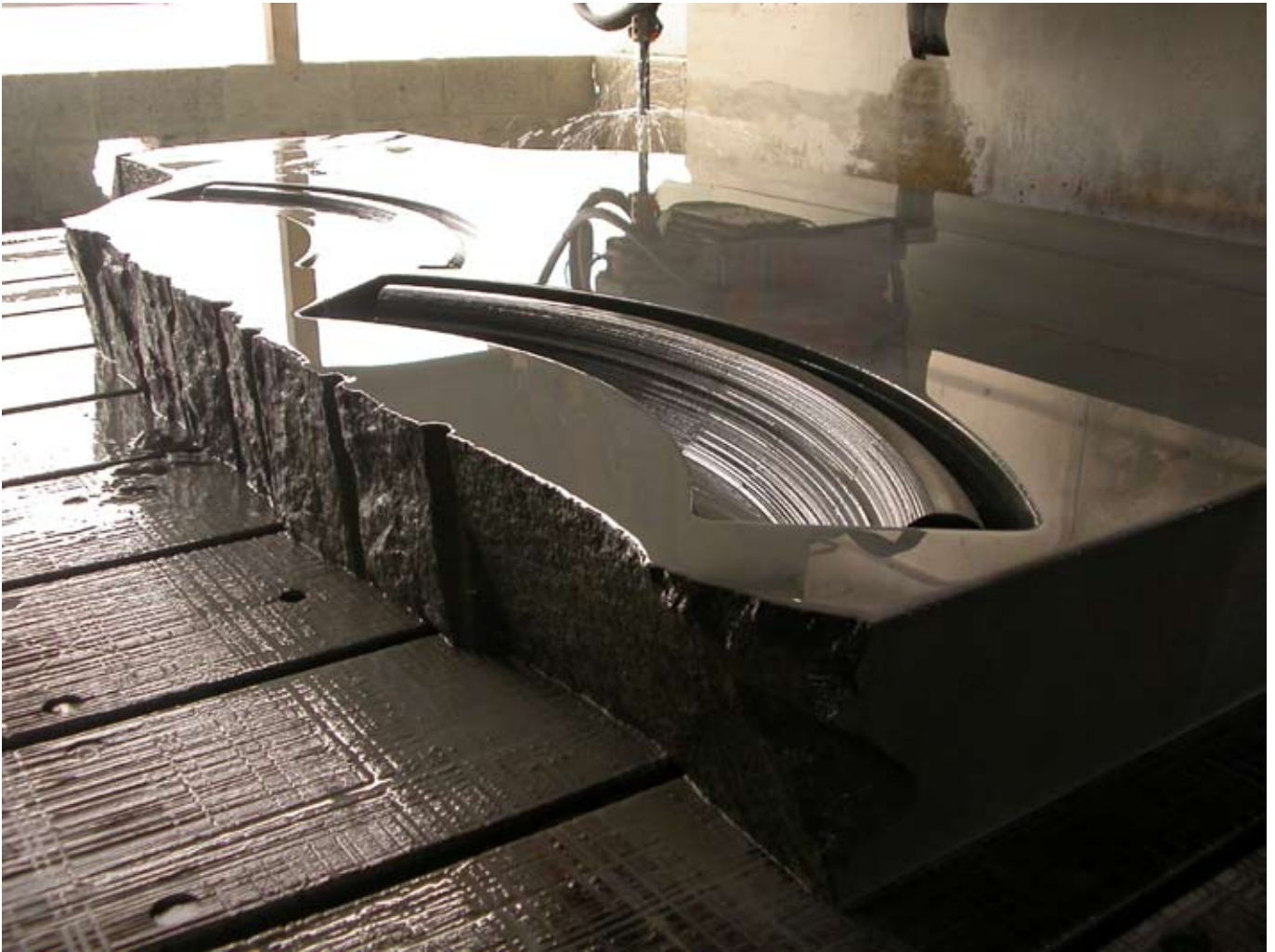
Sagomatura di due archi di Pietra Macigno da un unico blocco
