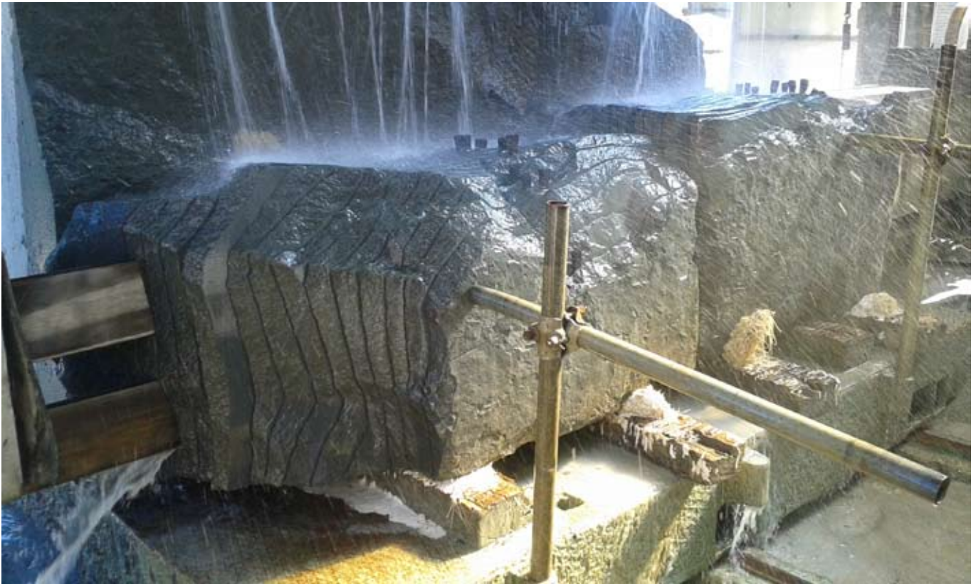
Il taglio di un blocco di Pietra Macigno al telaio
