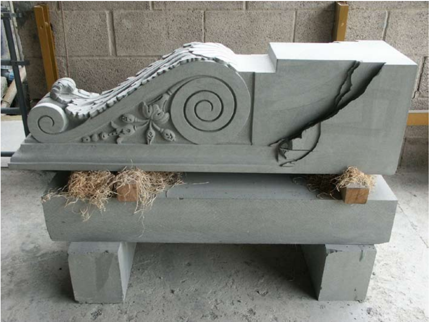
Cornice di Pietra Macigno fiammata e anticata. Si notano in particolare i nastrini che suddividono i vari elementi in conci
