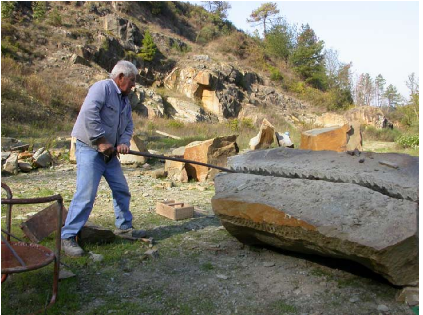
Fase dell'apertura del blocco di Pietra Macigno con il palo da leva
