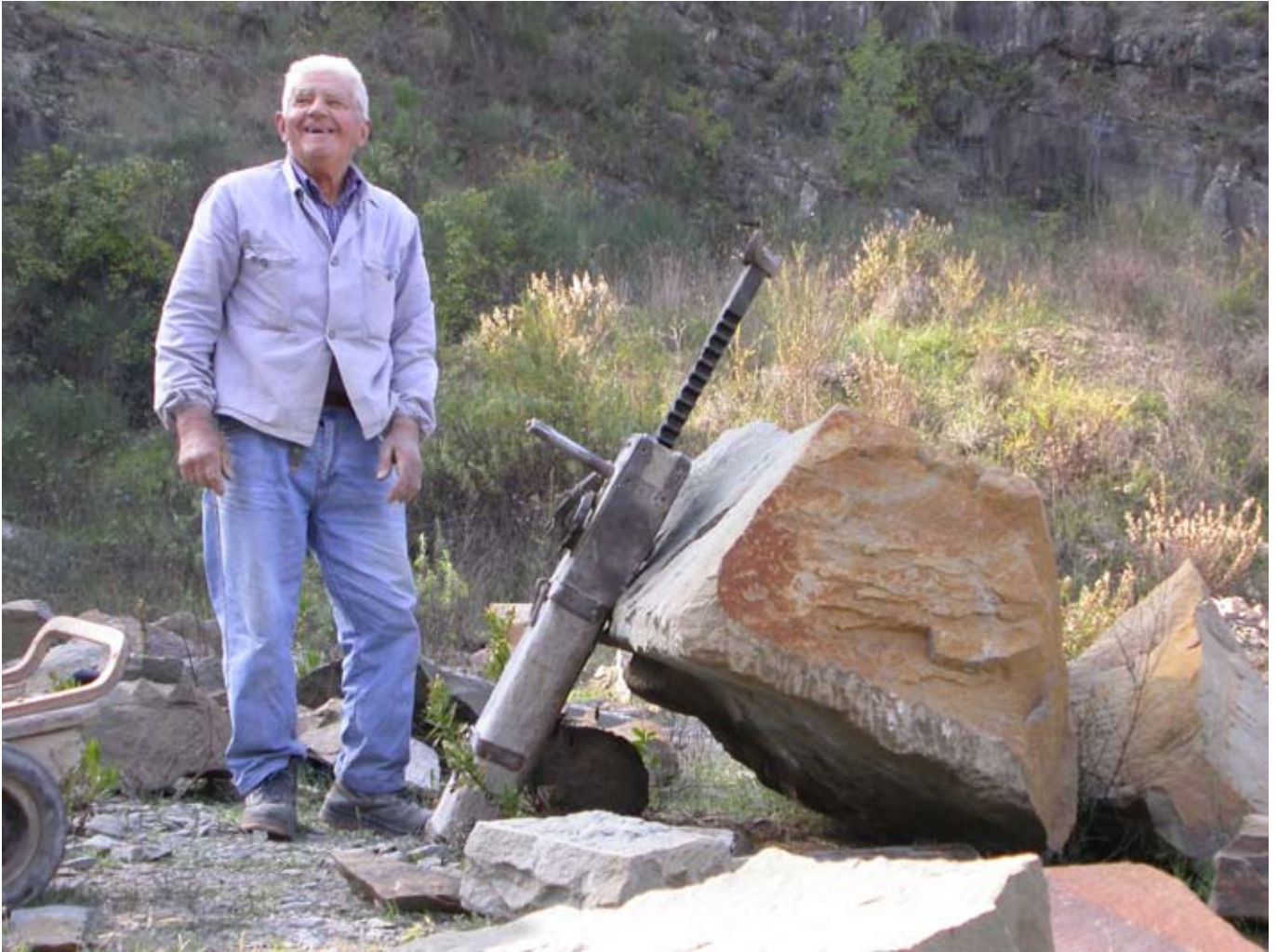
L'uso della binda per il sollevamento dei blocchi
