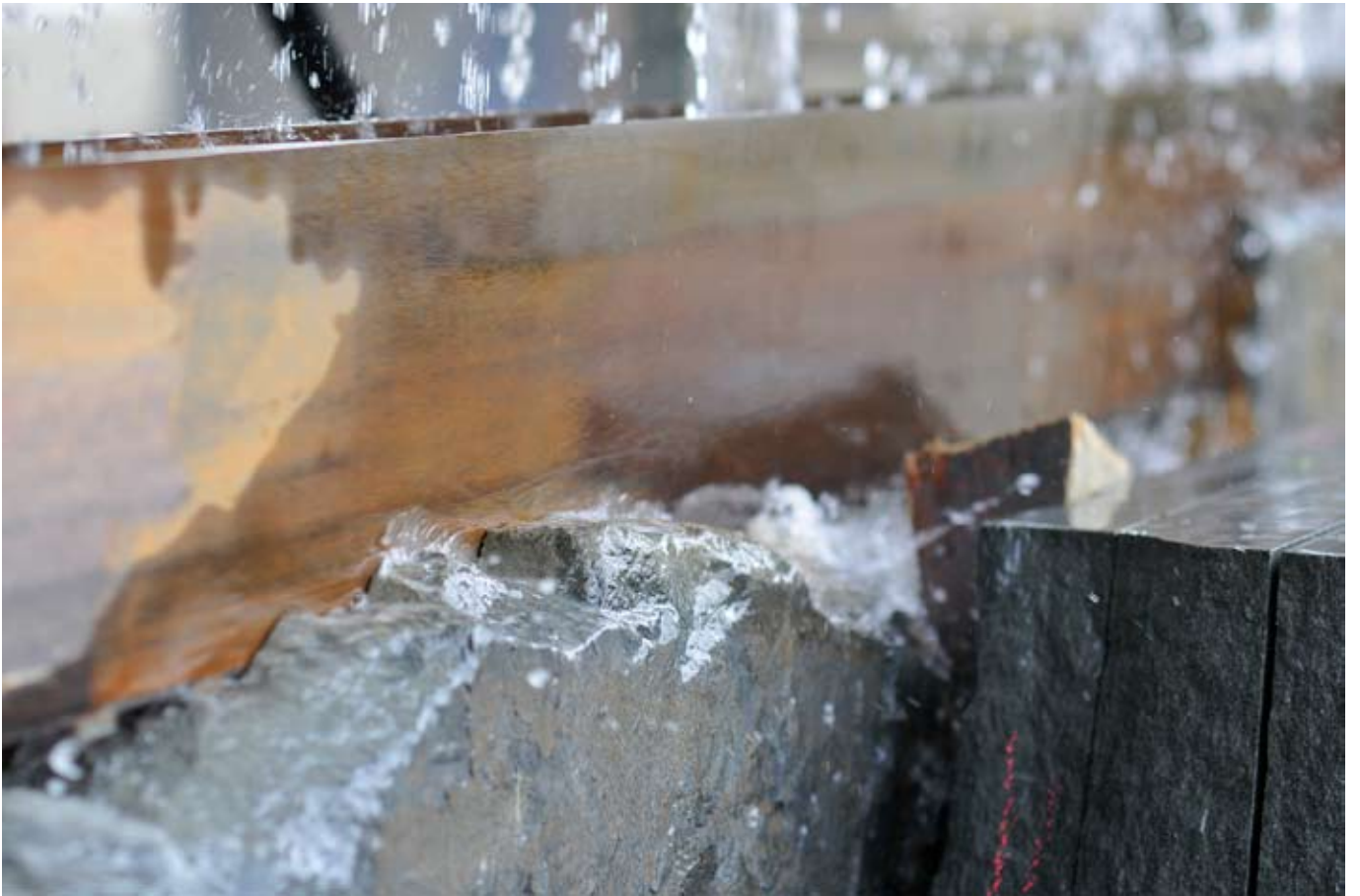
Particolare del taglio al telaio di una lastra di Pietra Macigno
