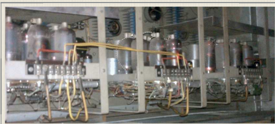
scheda ad inserimento nel circuito, con tecnologia a tubi elettronici anni 1950 - '55
