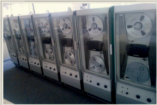
il grande calcolatore OLIVETTI – ELEA 9003, degli anni 1960, rimasto integro e funzionante, unico al mondo; è un grande assemblaggio di circuito a tecnologie ibride, avente cioè alcuni circuiti ancora a tubi elettronici (VALVOLE) ed altri a TRANSISTORI. E' conservato presso l'ITIS di Bibbiena - A R E Z Z O.
