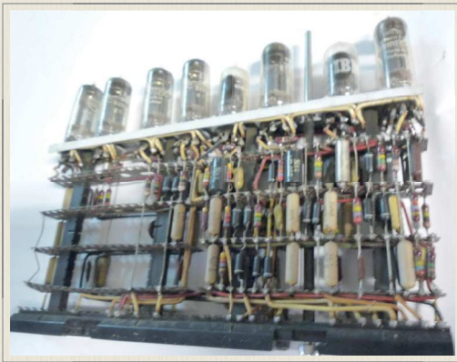
Scheda modulare a tubi elettronici di un computer IBM degli anni 1950; la guida di estrazione aveva già la forma standard mantenuta poi anche nelle schede successive a transistori ed anche in quelle più moderne, a circuiti integrati, che complessivamente costituivano il sistema del grande "calcolatore".
