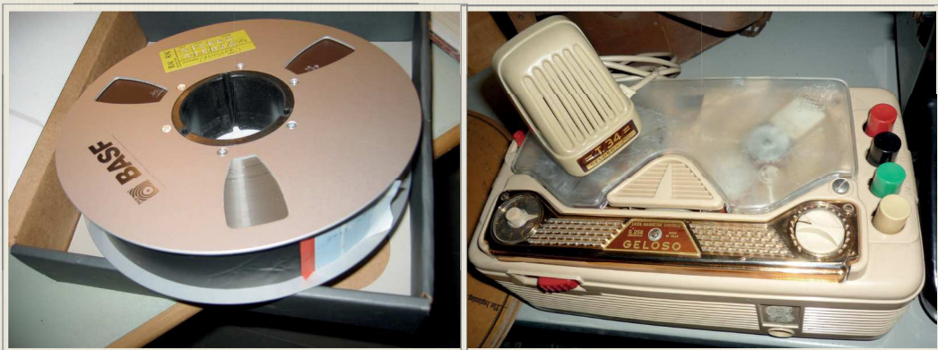
A sinistra , nastro da 2" in materiale plastico trattato con sostanza ferromagnetica per audio registrazioni, fino a 24 piste. A destra, piccolo registratore italiano, a nastro magnetico della "GELOSO" completo di microfono per registrazione .
