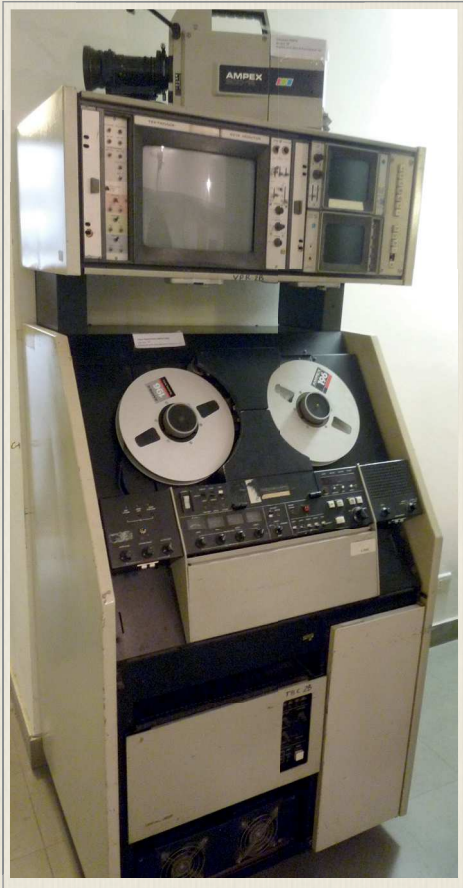
REGISTRATORI VIDEO A NASTRO MAGNETICO della ditta AMPEX” degli anni 1970; in alto, una telecamera portatile della stessa ditta AMPEX completa di obiettivo.
