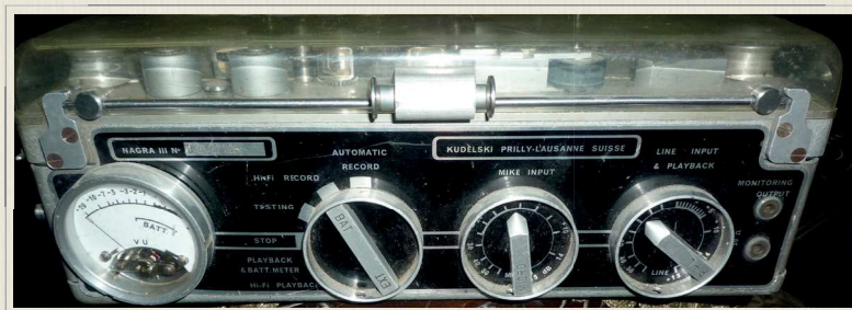
Raro registratore svizzero, ditta NAGRA, mod. III - a nastro magnetico usato per la prima volta dai giornalisti della RAI - RADIO-TELEVISIONE ITALIANA; con alimentazione a batteria tale da renderlo PORTATILE per le interviste mediante microfono.
