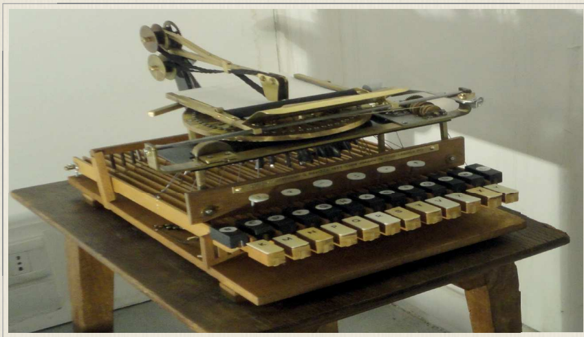
Il CEMBALO SCRIVANO – la PRIMA MACCHINA da SCRIVERE - 1855 – a caratteri mobili comandati da TASTI a doppia fila. La composizione è la stessa di quella dei CEMBALI MUSICALI e da questi ha preso il nome: CEMBALO SCRIVANO. Inventata da Giuseppe RAVIZZA di Vicenza nel 1855, dette l'impulso all'avvio della produzione americana che, in pochi anni, invase il mondo
