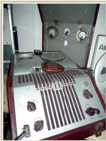
Filo di materiale magnetico in acciaio; Filo di nylon trattato con materiale magnetico; rulli vari di filo da registrazione; nella destra: REGISTRATORE AUDIO - SU FILO MAGNETICO degli anni 1930 - '50; fabbricazione americana della WEBSTER - CHICAGO, degli anni 1940 - '50; si notano due rulli avvolgitori di FILO MAGNETICO di FERRO, nelle rispettive sedi del coperchio; UN MICROFONO è poggiato sopra il registratore stesso.
