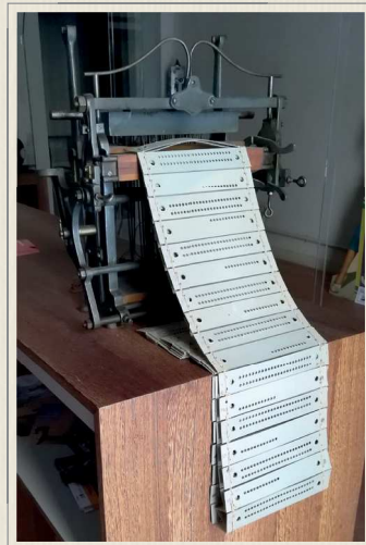
MACCHINA di JACQUARD per alzate di filo di ordito” marca: MAMBRETTI & C - MONZA , n. 2446 epoca: primi '900 - Dal Museo dell'Arte della Lana di STIA (AR)
