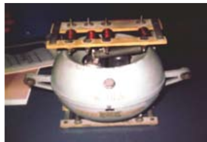
Figura 1b. Il risonatore a cavità rientrante (pentola)
