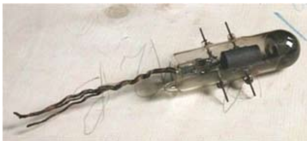
Figura 1a. Il triodo FIVRE 1628
