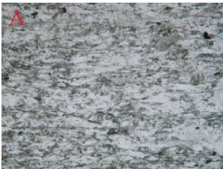
Figura 1a. Immagine al microscopio ottico a luce trasmessa (solo polarizzatore) di una sezione sottile (spessore ca. 30 micron) di un campione di Pietra del Cardoso; il campione è costituito principalmente da granuli di quarzo (cristalli bianchi) di circa 50 micron.
