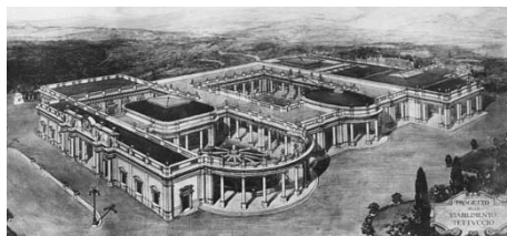
Ugo Giovannozzi, prospettiva aerea del progetto del nuovo Stabile Tettuccio. In difformità al progetto realizzato si notano la copertura del portico d'ingresso, l'emanatorio e la cupola ellittica della tribuna dell'orchestra
